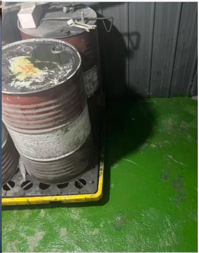
危废库贮存措施
